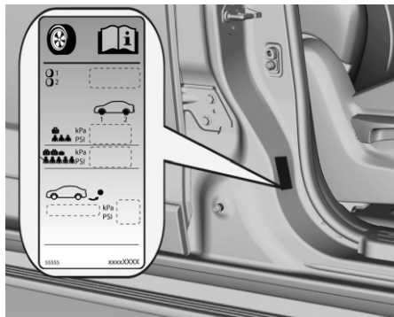
См. Давление воздуха в шинах ↪ 11-10 и табличку, расположенную на раме правой передней двери.
